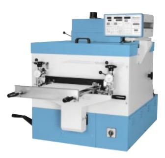
Das Rakelmesser wird von oben eingesetzt. Der Anstellwinkel ist variierbar. Die Streichdicke kann an Tastuhren eingestellt und abgelesen werden (Genauigkeit 0,01 mm). An zwei Griffen wird der Streichkopf über das Trägermaterial gezogen. Nach erfolgter Beschichtung muss der Streichkopf wieder gesenkt werden, damit der Nadelrahmen in den Trockner einfahren kann.
