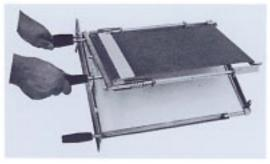
Auf diesem Spezialnadelrahmen ist das zu nadelnde Material in Längsrichtung zu spannen. Der innere Teil des Rahmens wird mit dem aufgenadelten Material gewendet, ohne dass es umgespannt werden muss. On this special pin frame the material is tensioned in length. The inner part of the frame with the pinned material can be turned. In this way it is possible to coat both sides of the sample without re-pinning.
