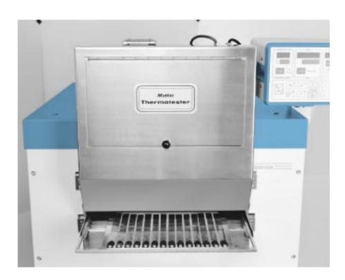
Einlegesieb mit Klammern für Musterstreifen, alle gleicher Grösse oder unterschiedlicher Grössen bis zur max. Siebfläche. Sieve part incl. holding clamps for sample stripes having all the same size or different sizes up to the full sieve area.
